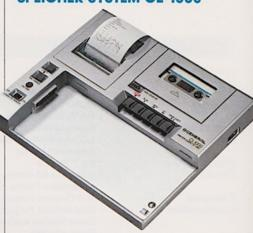
Computer, Drucker und Kassettengerät werden als eine Einheit zusammengestellt, deren Größe in fast alle Aktentaschen einpaßt. So braucht man nicht, ein separates Kassettengerät herumzutragen und sich um den Anschluß von Verbindungskabeln zu kümmern.
